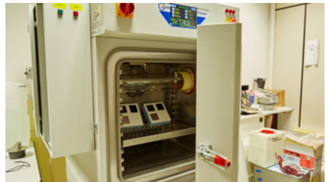
Test prestazionali sulla componentistica impiegata. Durabilità dei materassi, resistenza alle sollecitazioni, affidabilità e conformità alla regolamentazione europea nella progettazione del blocco cinture di sicurezza.
